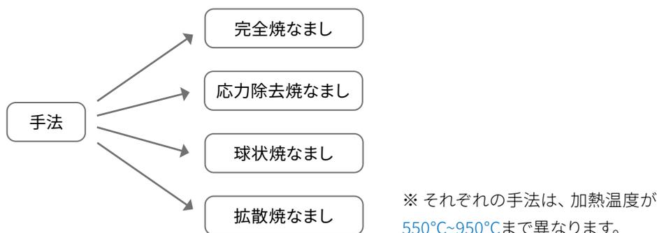
鋼を時間かけて冷却することで、その組織がパーライト構造に変化し、柔軟性が向上します。この均一な組織構造により、加工が容易になり、品質向上と加工ムラの防止に寄与します。
