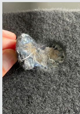
引き抜き試験は、 基板素材への集 約を示しています。
